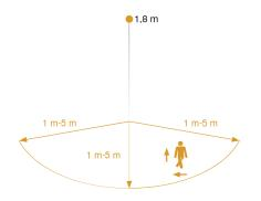
Mögliche Montagehöhe: 1,80 m – 2,00 m Orange: radial und tangential 3 skalierbare Achsen
